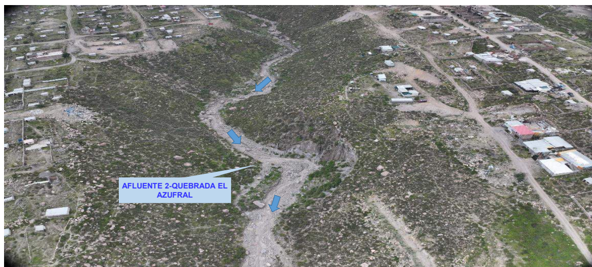
Imagen N° 3. Zona colmatada en el tramo, en donde se observa sedimentación en el cauce del Afluente 2 de la quebrada El Azufra.
